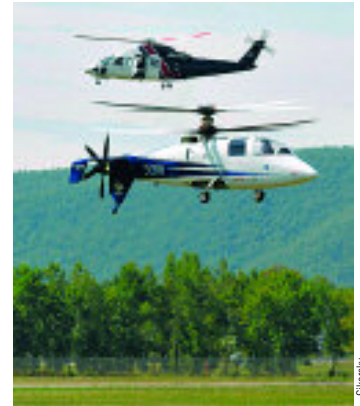
В ходе первого испытательного полета хвостовой толкающий винт был отключен
