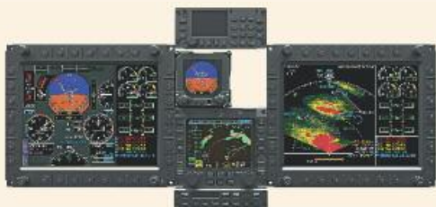
Комплекс бортового оборудования самолета DA-42Т КБО-42
