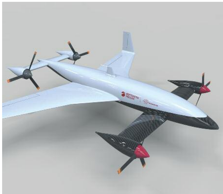
RHV-30 рассчитан на подъем до 5 кг полезной нагрузки
